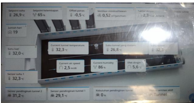
Gambar 3. SKOV sensor data suhu dan kelembaban kandang yang terukur Dari Punos 313
